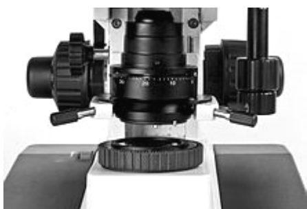
Рис.2.3. Система освітлення з конденсором
