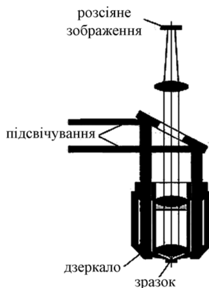
Рис.2.16. Схема темнопольної мікроскопії у світлі, що падає
